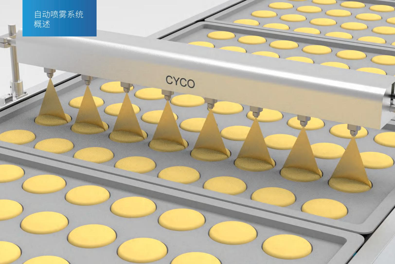
面包生产时最佳的喷涂需要精确控制流量，以确保昂贵的涂层仅在需要的地方和时间予以使用。当喷涂具有挑战性的浆料或巧克力时，精准控制喷涂温度同样至关重要。我们的流量和温度控制技术能确保质量和生产得以优化。
